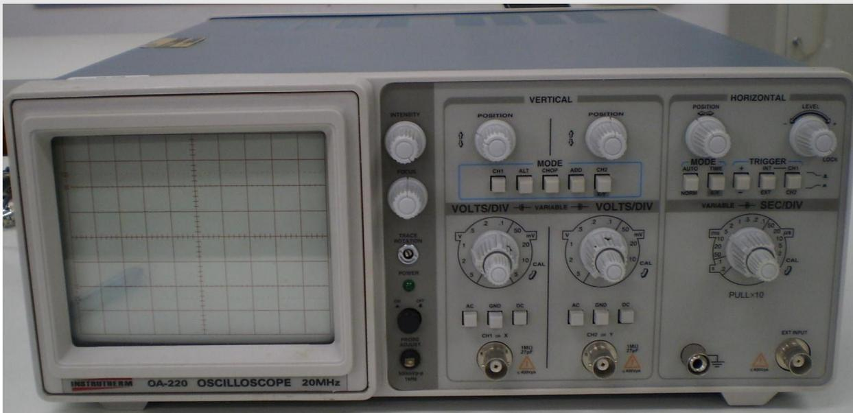
Os sistemas básicos do osciloscópio que utilizaremos no nosso curso são: mostrador, deflexão vertical e deflexão horizontal.
