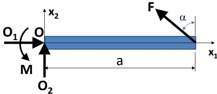
Figura 4.6 – Viga engastada em balanço com forças aplicadas reduzidas a um sistema força-binário.
