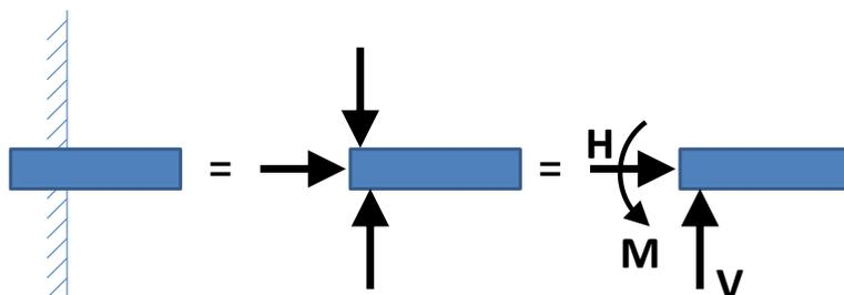
Figura 4.2 – Um corpo engastado tem os seus movimentos horizontal e vertical restringidos, assim como o giro em torno do eixo que sai do papel. Este tipo de apoio fornece duas forças e um momento de reação.
