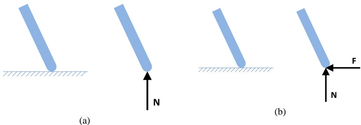
Figura 4.1 – Uma superfície sem atrito reage com um único esforço normal  $N$  (a) enquanto que na presença de atrito (b) a superfície reage também com uma força horizontal  $F$ .
