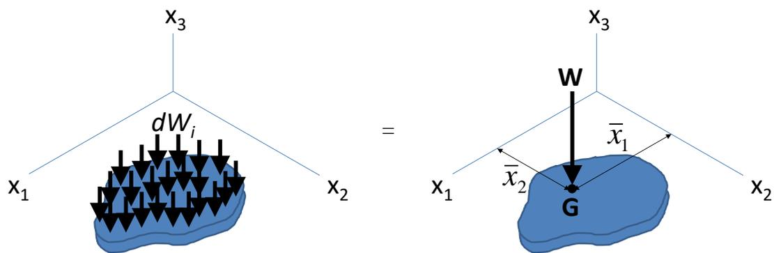
Figura 6.1 – O peso próprio de uma placa de espessura constante apoiada no plano  $x_1x_2$  está distribuído  $dW$  por toda a superfície de contato. O sistema equivalente consiste do peso total  $W$  aplicado no centro de gravidade  $G$  da placa.
