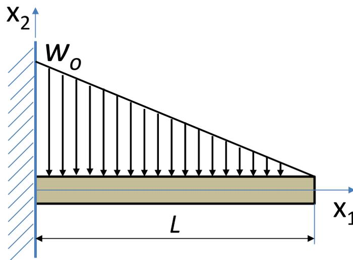
Figura 6.7 – Viga em balanço suportando um carregamento distribuído de variação linear.
