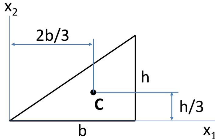
Figura 6.3 – Posição do centróide de um triângulo.
