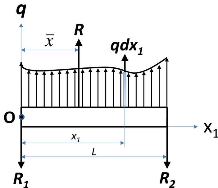
Figura 6.6 – Diagrama de corpo livre de uma viga bi-apoiada com um carregamento distribuído.
