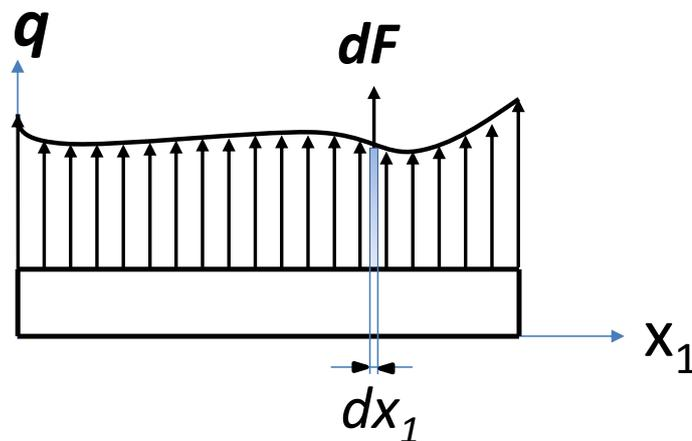
Figura 6.5 – Força continuamente distribuída de intensidade  $q(x)$ .
