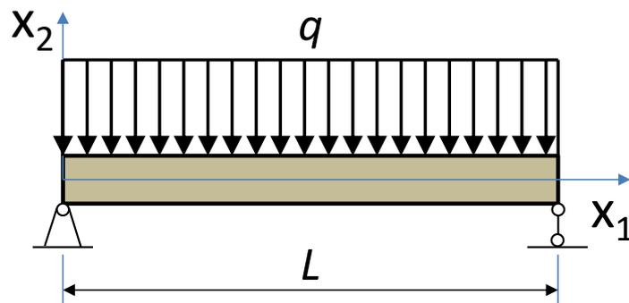
Figura 6.9 – Viga bi-apoiada solicitada pelo peso próprio de intensidade  $q$ .
