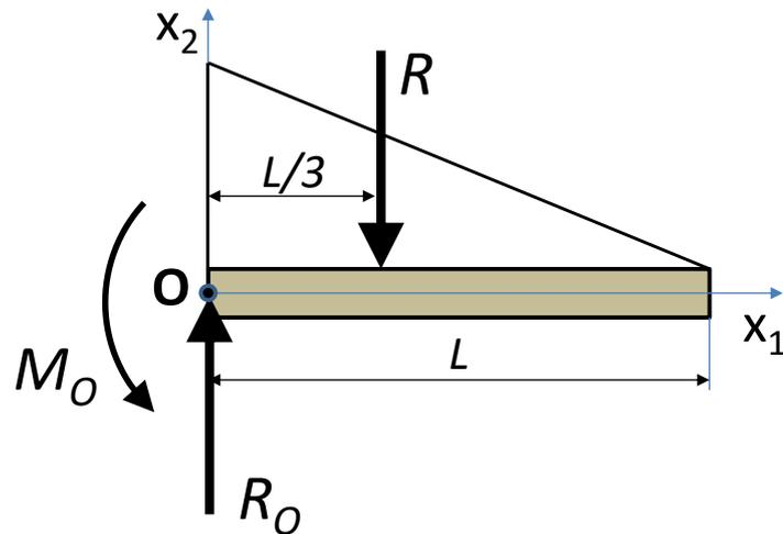
Figura 6.8 – Diagrama de corpo livre da viga em balanço da figura 6.7.
