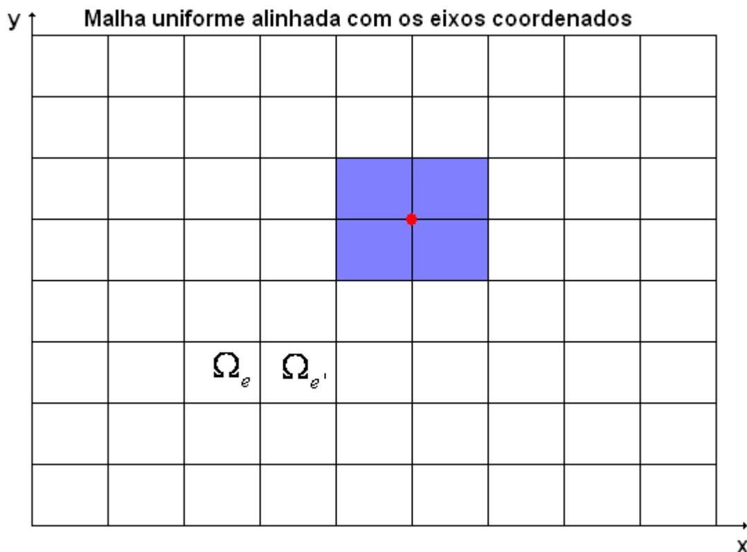
Mas se a malha não é deste tipo os cálculos analíticos são muito trabalhosos. Neste caso é necessário realizar uma transformação (**mapeamento isoparamétrico**) para que todos os elementos sejam transformados em um único elemento (**elemento padrão**).
