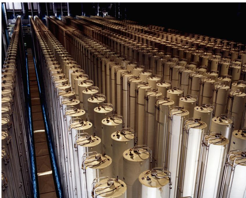
Figura 1.4: Arranjo real de centrífugas [31].
