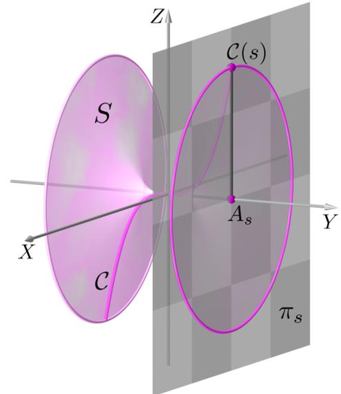
Fig. 9: Superfície de revolução  $S$  gerada pela curva  $\mathcal{C}$
