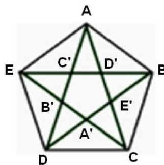
Os pontos  $A'$ ,  $B'$ ,  $C'$ ,  $D'$  e  $E'$  dividem as diagonais do pentágono de modo notável: cada um deles divide uma diagonal em dois segmentos desiguais, tais que, a relação entre as medidas da diagonal e do segmento maior (=lado do pentágono) é igual à relação entre as medidas do segmento maior e do segmento menor.
