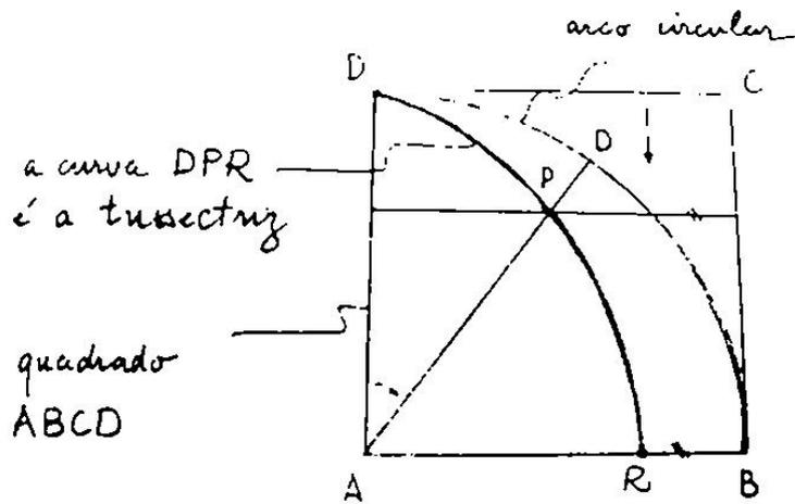
AD gira com um movimento circular uniforme em torno e A até que coincida com o lado AB. Ao mesmo tempo o lado DC desce com velocidade constante até coincidir com AB. Os dois movimentos estão sincronizados de maneira que ambos os lados DC e AD coincidam com AB no mesmo instante. A trissectriz é o lugar geométrico gerado pelas interseções destes dois lados móveis.
