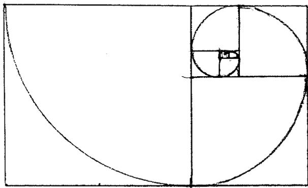
Se em vez de partir de um retângulo de ouro, se parte de um retângulo de Fibonacci com lados  $F_{n-1}$  e  $F_n$ , onde  $F_{n-1}$  e  $F_n$  são dois números de Fibonacci consecutivos, obtém-se uma espiral formada de quartos de círculos dita espiral de Fibonacci que aproxima a espiral de ouro.
