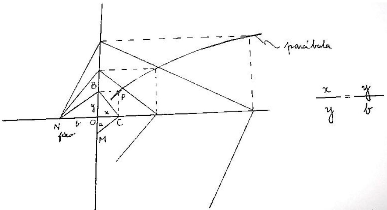
O ponto P é o ponto de interseção das duas curvas. OC é um segmento que mede  $\sqrt[3]{\frac{b}{a}} a$ .
