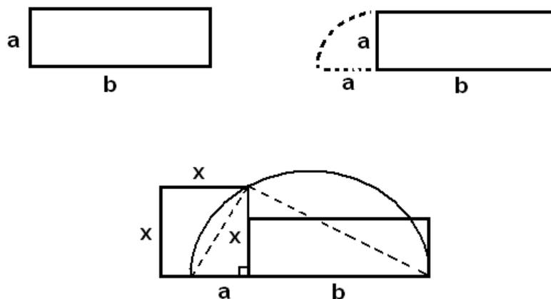
No triângulo retângulo,  $\frac{a}{x} = \frac{x}{b}$  (a altura  $x$  é a média proporcional entre os dois segmentos que ela determina sobre a hipotenusa).
