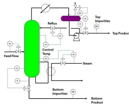
Controle de uma coluna de destilação
