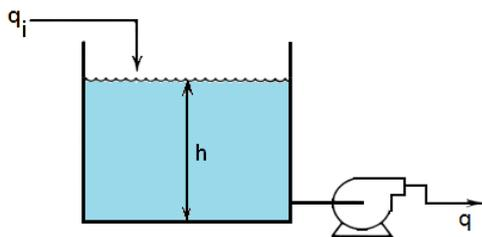
Sistema de nível de líquido com uma bomba é um processo instável (ou não-auto-regulatório).
