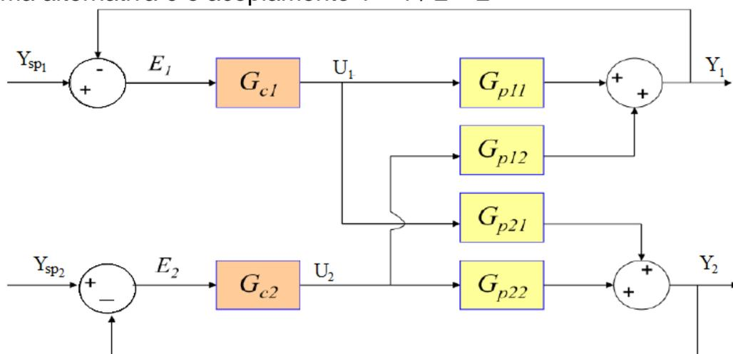
Neste esquema de conexão pode identificar-se uma “malha oculta” que apresenta a interconexão das malhas mais além do esquema principal. Esta malha “oculta” tende a desestabilizar as outras malhas e a fazer o ajuste mais difícil.
