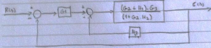
$$C(s) = \left[ \frac{(G_2 + H_1) \cdot G_3}{(1 + G_2 \cdot H_2)} \right] \cdot (G_1 \cdot R(s) - H_2 \cdot C(s) - G_1 \cdot C(s))$$
