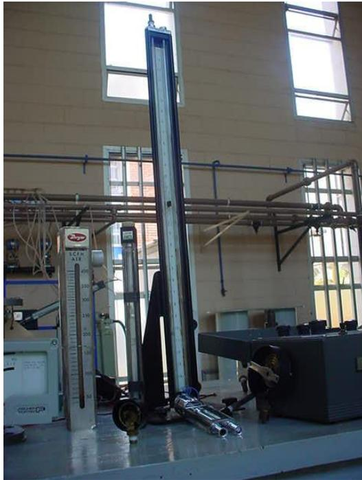
Manômetro de tubo em "U" com fluido manométrico
