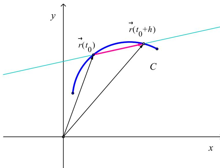
**DEFINIÇÃO 2.4.1: (Vetor tangente unitário)** Seja  $\vec{r}$  é uma função contínua e injetora. Dado um ponto  $\vec{r}(t_0) \in C$ , se  $\vec{r}'(t_0)$  existe e é não-nulo, definimos o vetor  $\vec{t}$ , dado por  $\vec{t}(t_0) = \frac{\vec{r}'(t_0)}{\|\vec{r}'(t_0)\|}$ , como o *vetor unitário tangente* à curva  $C$ , parametrizada por  $\vec{r}$ , no ponto  $\vec{r}(t_0)$ .
