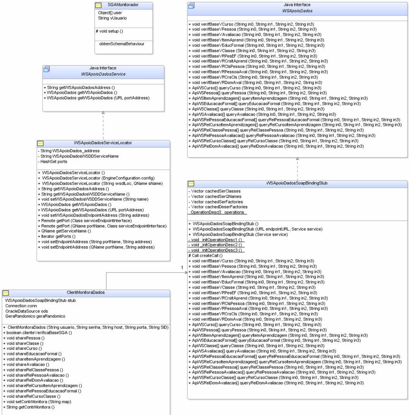
FIGURA 77 – Diagrama de classes para o processo de monitoração
