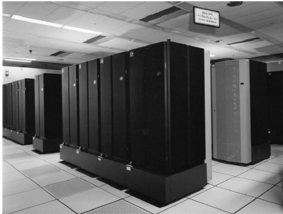
**FIGURA 9.11.4 O IBM RS/6000 SP2 com 256 processadores.** Esta máquina de memória distribuída é construída usando placas de computadores desktop inalteradas, além de um switch personalizado como a interconexão. Comparado com o SP2, a maioria dos clusters usa uma rede local comutada original. A foto é cortesia do Lawrence Livermore National Laboratory.
