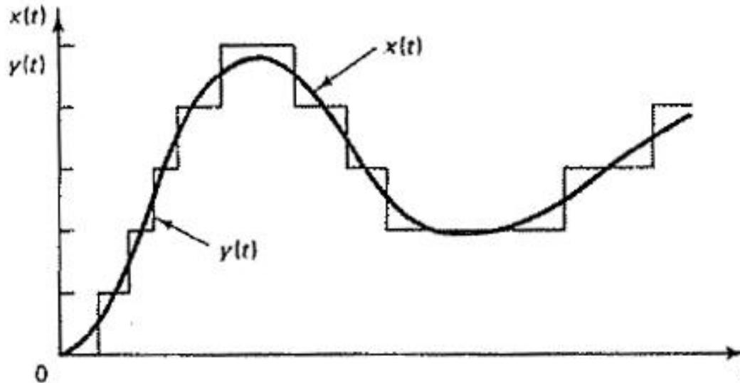
Se um sistema estiver representado pelas suas equações de Laplace, as fórmulas de recorrência que representam seu comportamento podem ser obtidas pela transformada Z
